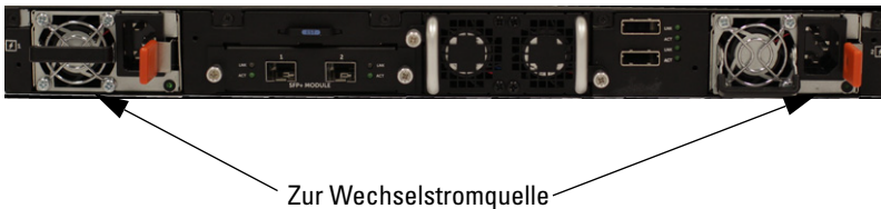
Abbildung 1-26. Zwei redundante Netzteile am Switch-Modell N3048
